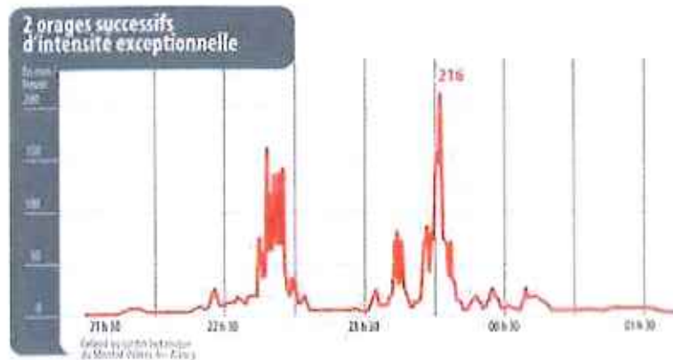
Figure 12 : Intensité des précipitations (mm/h) lors des épisodes orageux de la nuit du 21 au 22 mai 2012 dans l'agglomération de Nancy (CU Grand Nancy)
